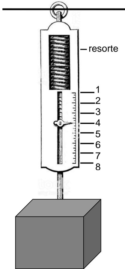
Este instrumento permite medir el peso de los objetos, y su funcionamiento se basa en el estiramiento de un resorte que obedece la ley de elasticidad de Hooke. Para este caso el instrumento mide un valor de 4 N para el cubo de madera. (ver figura adjunta).
